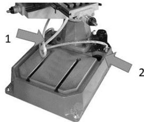
Das Kühlmittel kann am Fuß an den beiden markierten Stellen (1,2) eingefüllt werden – siehe Bild links.
