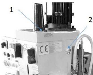
Schraube 1 entfernen. Öl auffüllen bei bis Ölsaugglas bis zur Mitte gefüllt ist. Maschinekopf muss dafür in senkrechter ( $0^\circ$ ) Position stehen. Anschließen Schraube 1 wieder montieren.
