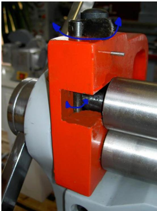
Přední horní válec lze na jedné straně vyjmout otočením křídlového šroubu o 90°, aby bylo možné odebrat uzavřené kruhové obrobky. Kromě toho je třeba vyšroubovat přídržné šrouby na obou stranách, které slouží k zajištění horního válce.
