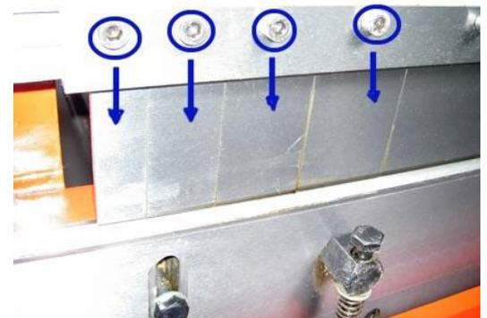
Pomocí funkce ohýbání lze v závislosti na velikosti obrobku odebírat nebo vyměňovat segmenty různé šířky, takže lze vytvořit definovanou ohybovou hranu. K tomu stačí povolit šroub příslušného segmentu, abyste jej mohli posunout nebo vyjmout.
