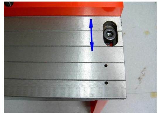
Bei der Abkantungfunktion können je nach Werkstückgröße die verschiedenen breiten Segmente herausgenommen bzw. ausgetauscht werden, sodass eine definierte Biegekante erzeugt werden kann. Hierzu muss lediglich die Schraube des entsprechenden Segmentes gelöst werden, um dieses zu verschieben bzw. herausnehmen zu können.
