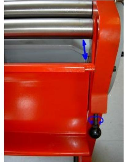
Le rouleau supérieur avant peut être retiré d'un côté en tournant la vis à oreilles de 90°, afin de pouvoir éventuellement retirer des pièces circulaires fermées. En outre, il faut dévisser les vis de maintien disposées de part et d'autre, qui servent à la fixation sûre du rouleau supérieur.
