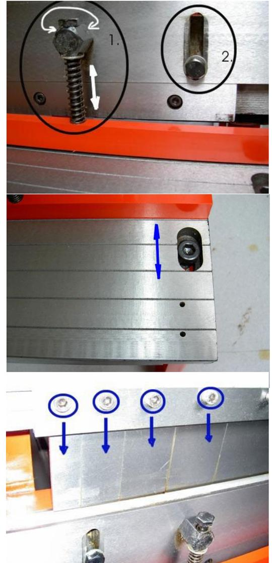
Pour la fonction de rouleau, il est possible de régler le rouleau arrière et le rouleau supérieur. À l'arrière de la machine, un bouton rotatif à gauche et à droite permet de régler la distance entre le rouleau arrière et les deux autres, et donc le diamètre du rouleau. Si ce rouleau n'est pas ajusté parallèlement, des enveloppes coniques peuvent par exemple être créées.
