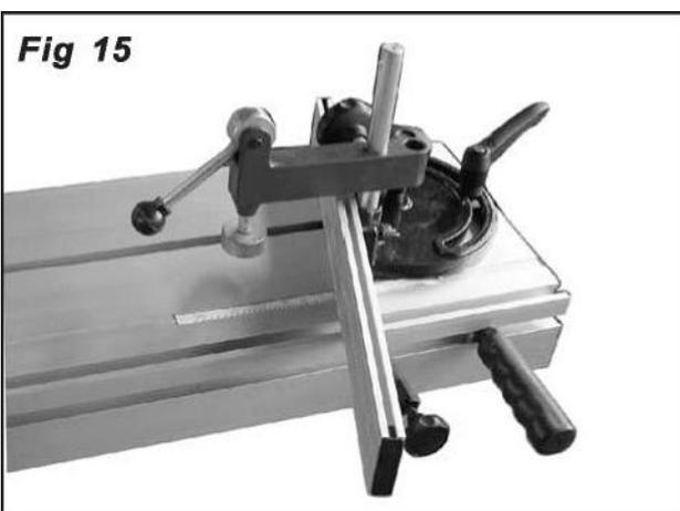
Justieren Sie nun mittels der **4 M12** Sechskantschrauben **C** den Tischausleger so, dass er in Linie mit dem Formattisch ist. Prüfen Sie dies mittels ein ebenes Objekt über beide legen und mit einer Wasserwaage kontrollieren. Wenn Sie mit der Einstellung zufrieden sind, ziehen sie **C** an.
