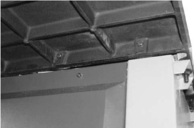
Montieren Sie den Tischausleger mittels **4 M8x20** Schrauben/Beilagscheiben am Formatschiebetisch.
