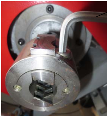
Werkzeugwechsel Innensechskant- Schlüssel 6mm
