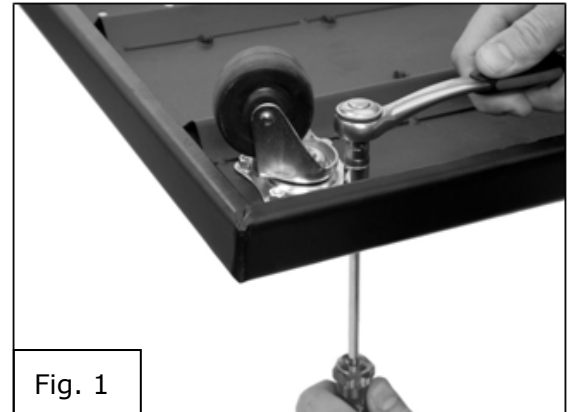
Bild 1 Anbau der Lenkrollen / Mounting of the swivel casters / El cultivo de ruedas
